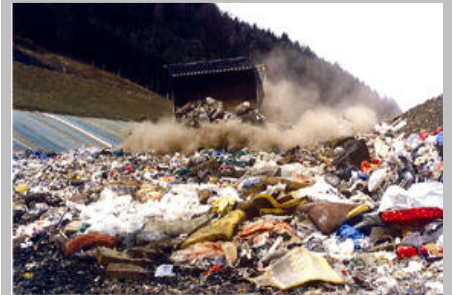
Der Kompaktor mit dem der Restmüll verdichtet wird, wiegt rd. 33 Tonnen.
